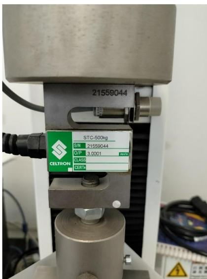
Figura 18. Máquina universal de pruebas marca CMS Metrology.
