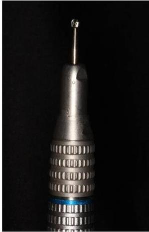
*Figura 8. Fresa de tungsteno de carburo en forma de bola No. 3.*
