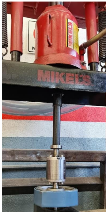
Figura 23. Inserción del rodamiento en el rotor (Autoría Propia).
