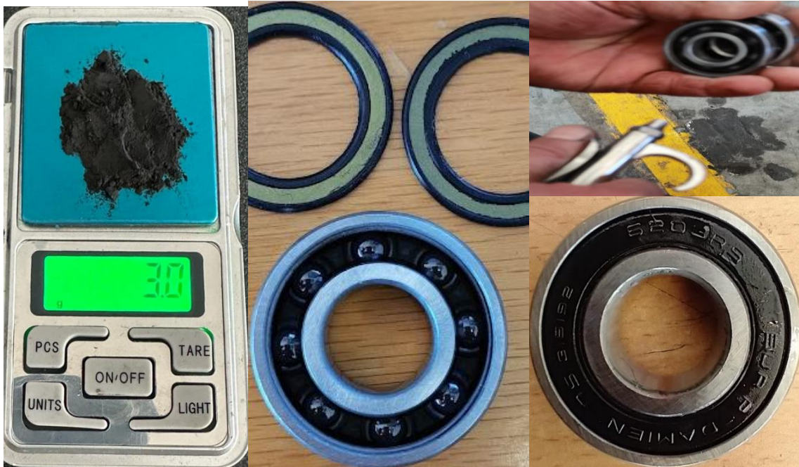
Figura 17 Inducción de fallo de contaminación en la lubricación (Autoría Propia)
