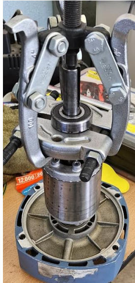
Figura 22. Extracción del rodamiento (Autoría Propia).
