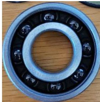
Figura 14. Rodamiento Híbrido empleado (Autoría Propia).
