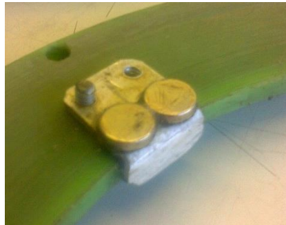
Figura 52. Vista a detalle de los imanes del estáticos del rodamiento magnético
