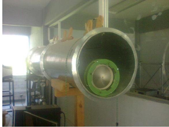
Figura 60. Modelo puesto a prueba en el túnel de viento
