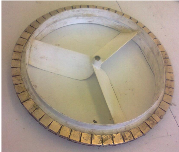
Figura 49. Imanes del rodamiento magnético del rotor.
