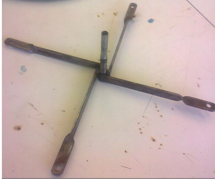
Figura 53. Eje y soporte del eje para la restricción radial.
