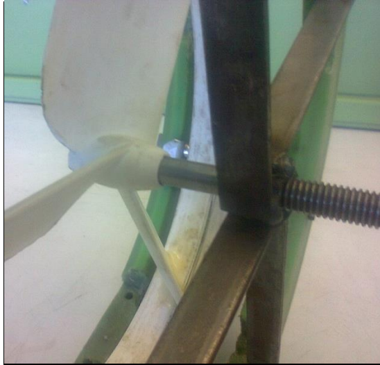
Figura 55. Vista a detalle del buje para restringir la posición radial
