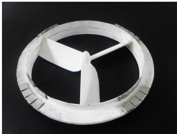
Figura 48 modelo de las aspas y aro impresos en polímero ABS
