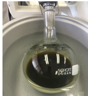
Figura 21. Fotografía del Extracto Metanólico filtrado en un matraz de bola a baño maría listo para roto-evaporar.
