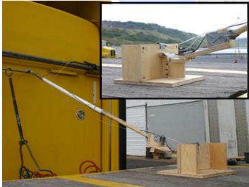
Figura 4.7 - Montaje del sensor para medición del ángulo de la articulación de vehículo (Bortoni 2007).
