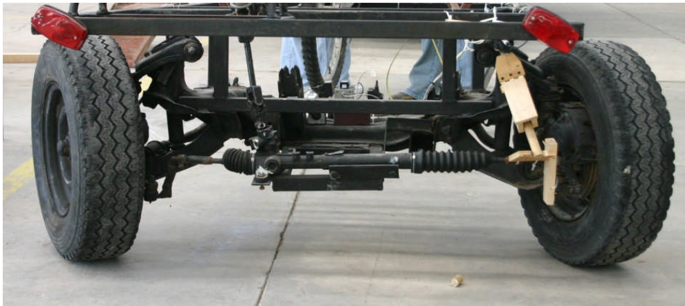
Figura 8.3 – Eje direccional en el semirremolque (Bortoni 2008).
