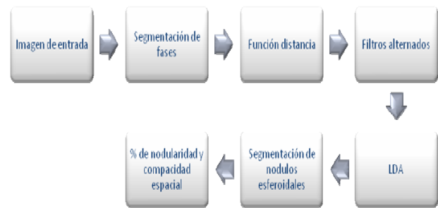
Fig. 3-Metodología de segmentación morfológica nodular. Inicialmente, y con el objetivo de evitar el uso de técnicas basadas en umbrales, la imagen original a 200X (ver Fig. 4(a)) es filtrada. Esto es llevado a cabo mediante el uso de filtros por reconstrucción. Sea f la imagen original, para todo punto “x” de la imagen se obtiene una segunda imagen a partir de la suma g(x)=f(x)+c , donde c es una constante que en nuestro caso, después de haber realizado un estudio sobre la totalidad de la imágenes tiene un valor de 60. Se tomaron valores entre 50 a 80 de manera heurística para determinar el valor de c . Posteriormente se realiza la reconstrucción de g en f , es decir, R^*(f, g) . La imagen en Fig. 4(b) ilustra el resultado obtenido. A partir de esta imagen filtrada se pueden obtener directamente los nódulos calculando los mínimos de la imagen como se muestra en la Fig. 4(c). Podemos observar que los nódulos que tocan los bordes han sido eliminados. Una vez extraídos los nódulos, se procede a separar aquellos que se
