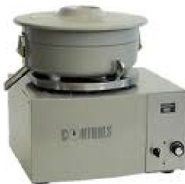
Figura 3-3 Equipo de extracción del asfalto en el RAP
