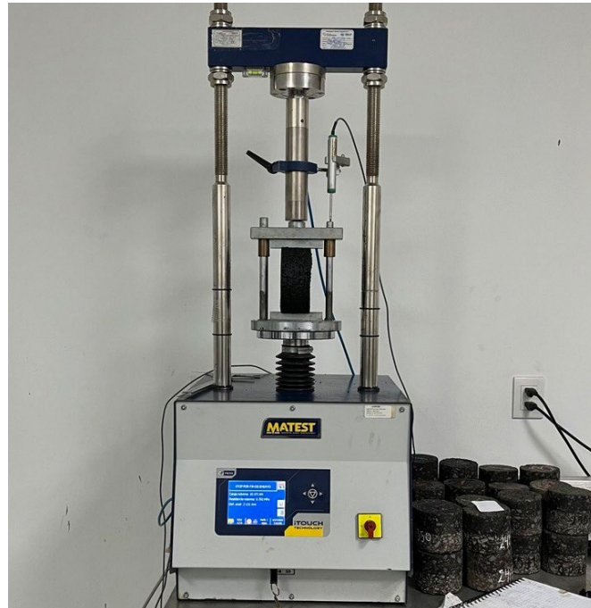
Figura 3-9 Equipo para la evaluación de daños por humedad
