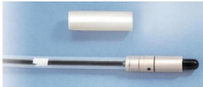
Figura 5.1: Cámara CC13 utilizada como cámara de referencia durante las mediciones realizadas.
