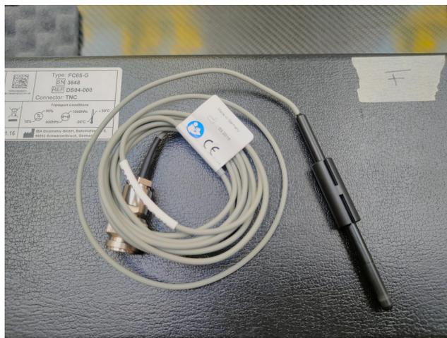
Figura 5.2: Diodo **RFD 3<sup>G</sup>-pSi** utilizado en las mediciones dosimétricas
