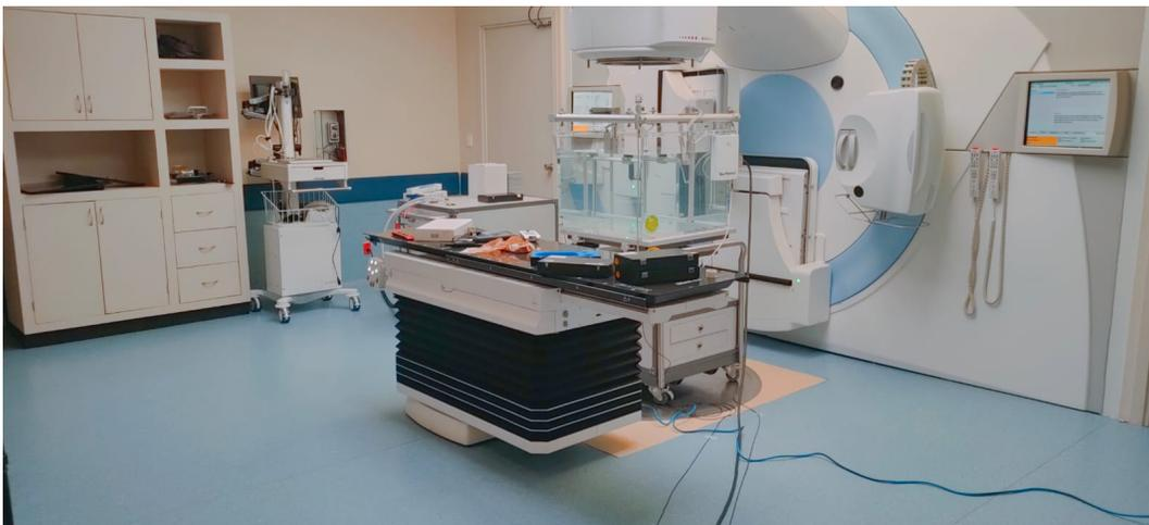
Figura 6.1: Acelerador lineal Elekta Infinity en la UEO. Y bajo el cabezal, Blue Phantom <sup>2</sup>
