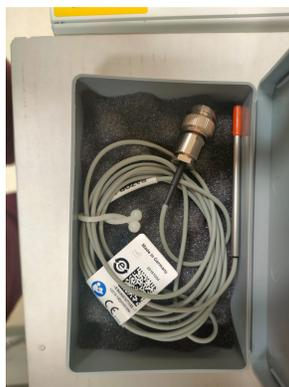
Figura 5.3: Detector RAZOR™ utilizado en las mediciones dosimétricas
