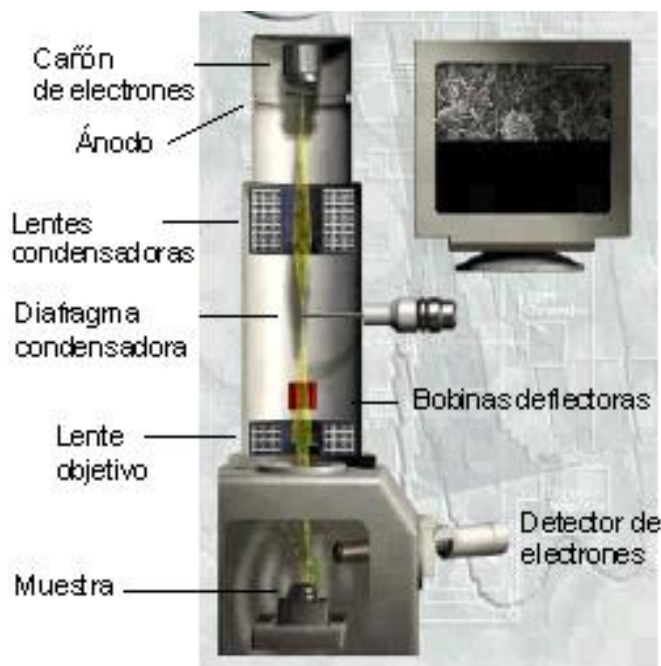
Figura 13 Partes del equipo de SEM. [39]
