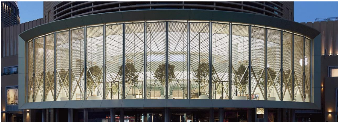
Ilustración 76: Edificio Apple Store en Dubari, cuenta con un sistem de control solar domótico que permite la apertura o cierre de los parasoles de acuerdo a la temperatura interna. Fuente: esquireme.com
