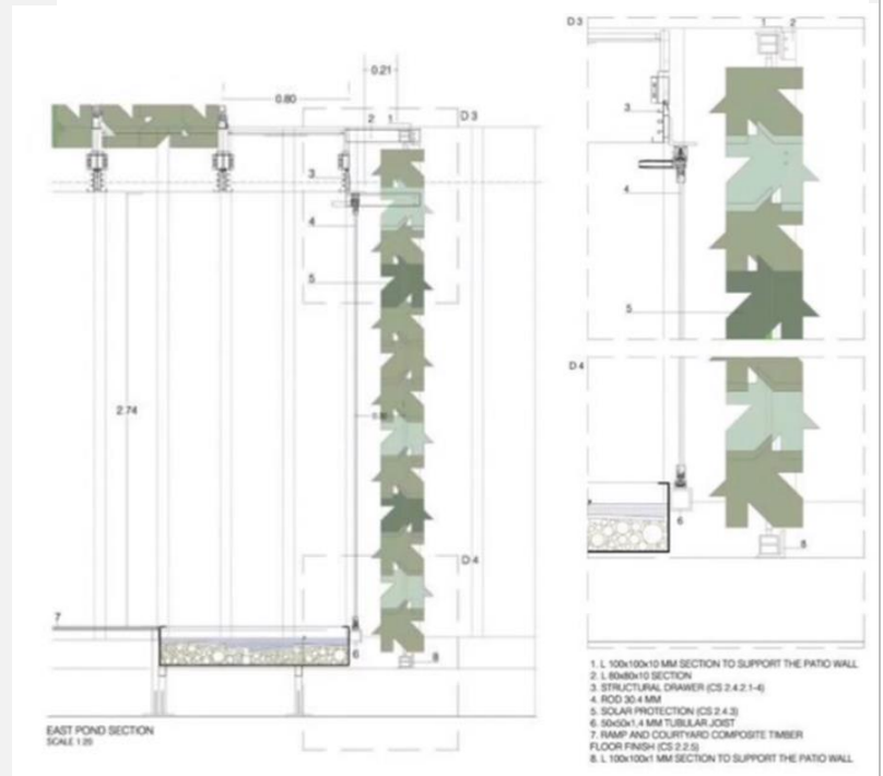
Figura 32: Detalle de apertura de lamas en la envolvente en sección [10].
