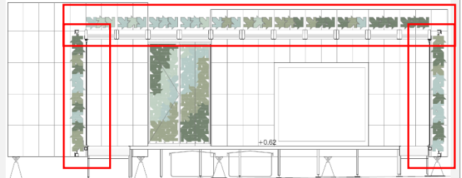
Figura 30: Detalle de lamas en la envolvente en sección [10].
