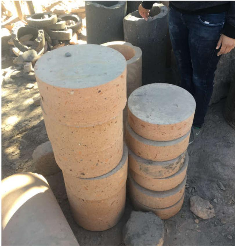
Figura 2.5: Discos residuales de la elaboración de columnas (Fuente propia).
