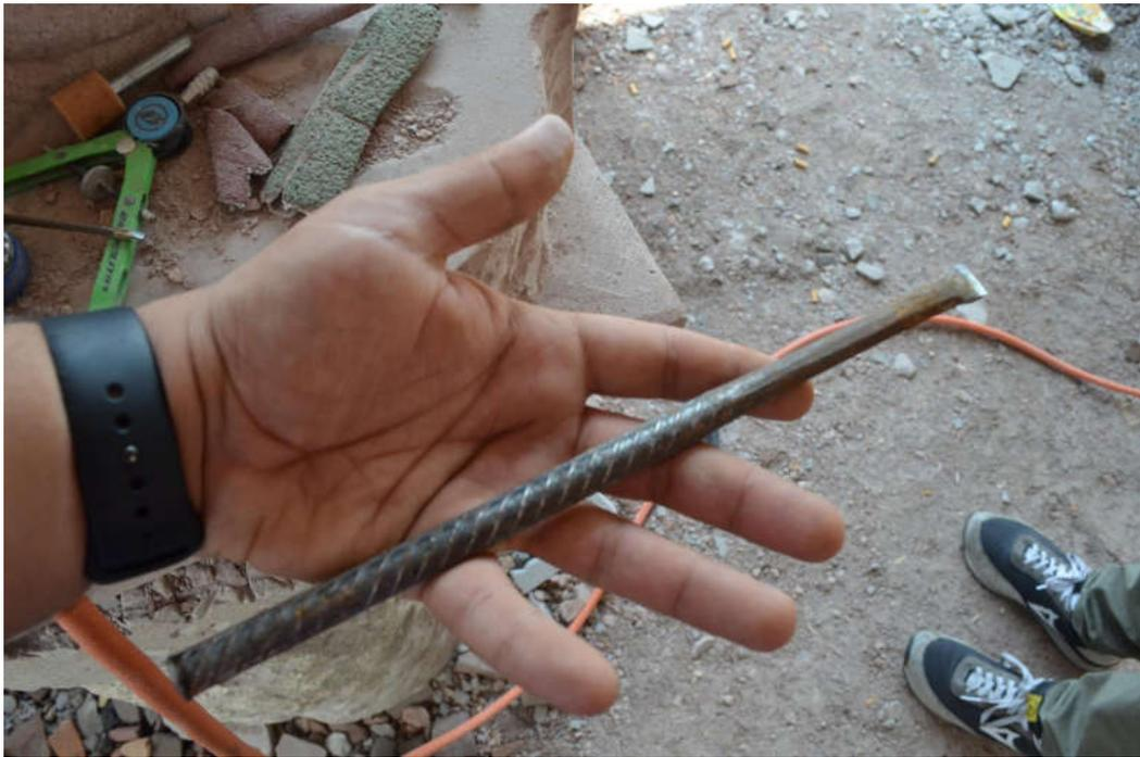
Figura 2.6: Ejemplo de cincel elaborado con varilla de construcción en la misma comunidad (Fuente propia)
