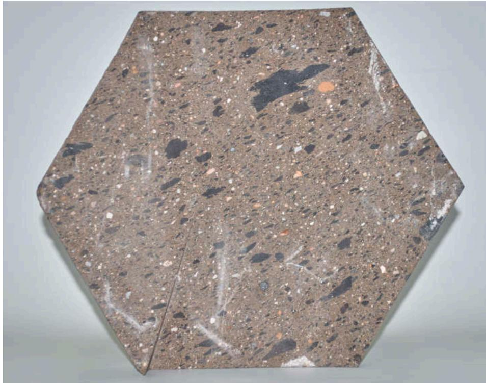
Figura 5.3: Módulo hexagonal en cantera gris. (Fotografía propia)
