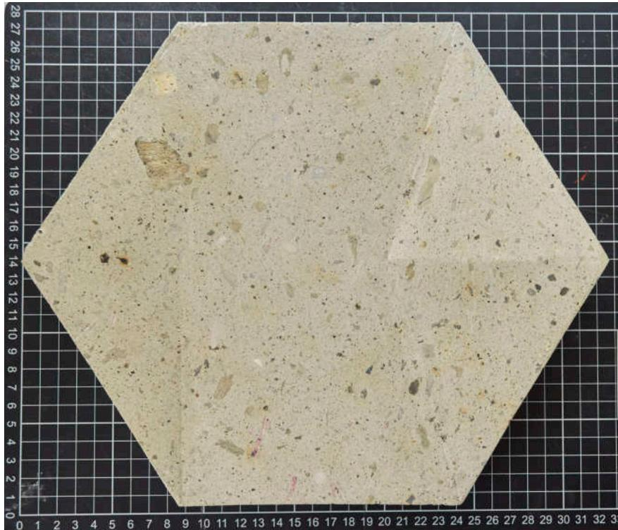
Figura 5.2: Módulo hexagonal en cantera gris. (Fotografía propia)
