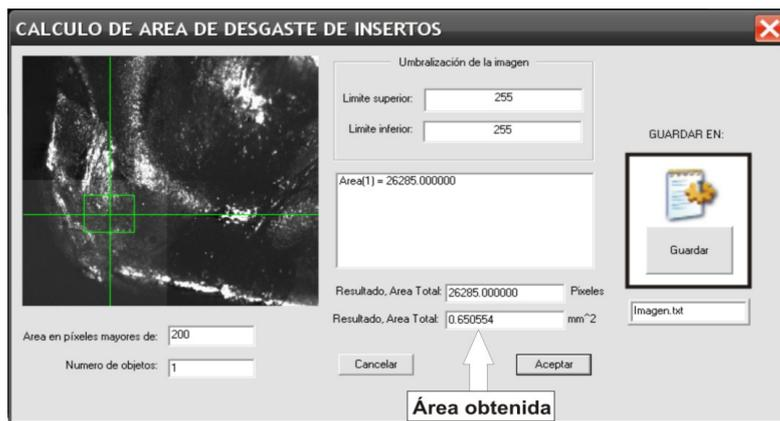
Figura 3.4. Cálculo del área de desgaste de flanco mediante el software.
