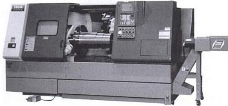
Figura 2.1. Torno CNC típico.
