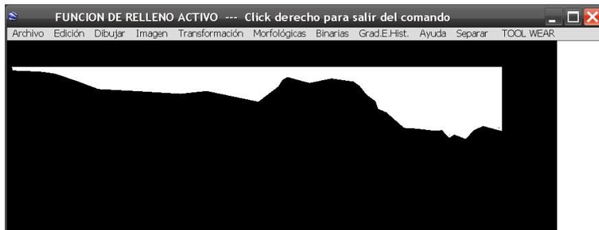
Figura 3.3. Área de desgaste totalmente rellena.
