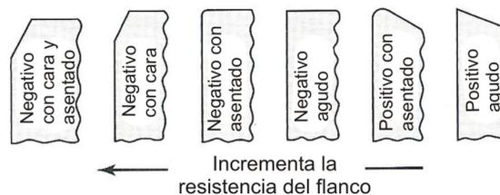
Figura 2.8. Preparación del filo de insertos para mejorar su resistencia.
