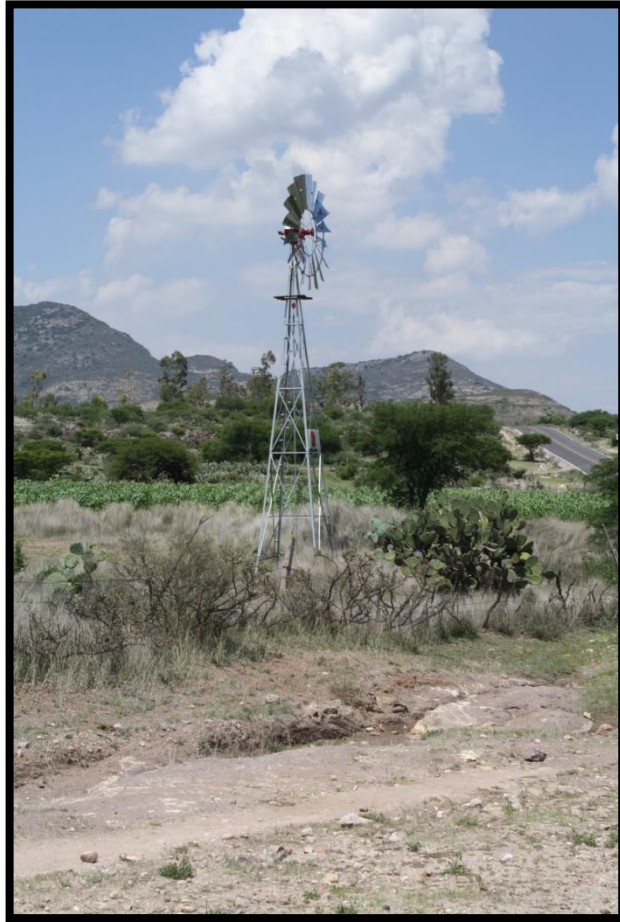
Fotografía 11. Bomba eólica para la extracción de agua. La Carbonera, 30 de abril del 2015.
