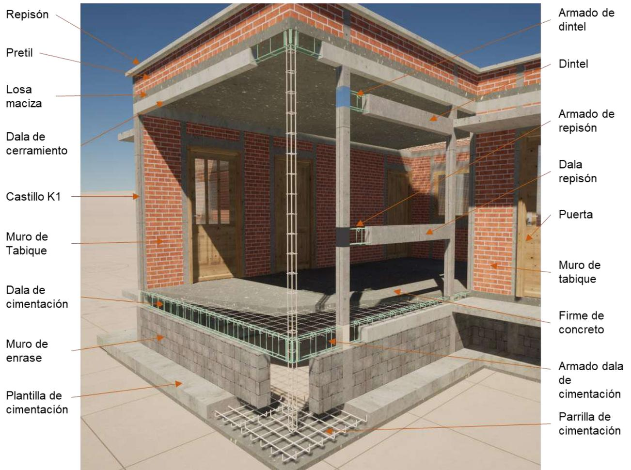
En la figura anterior, también es posible apreciar la conexión que existe entre el acero de refuerzo del castillo tipo K1 con la parrilla de cimentación, mismo que permite desde el cimiento, brindarle estabilidad a la estructura de carga.
