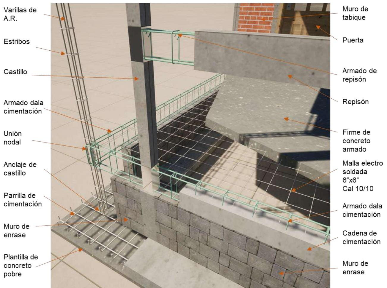
Como se ha dicho, la estructura de la base de la vivienda, está conformada por una zapata corrida que contiene un muro de enrase y una dala de cimentación, misma que permite que, la estructura de acero de refuerzo del firme de planta baja, se amarre
