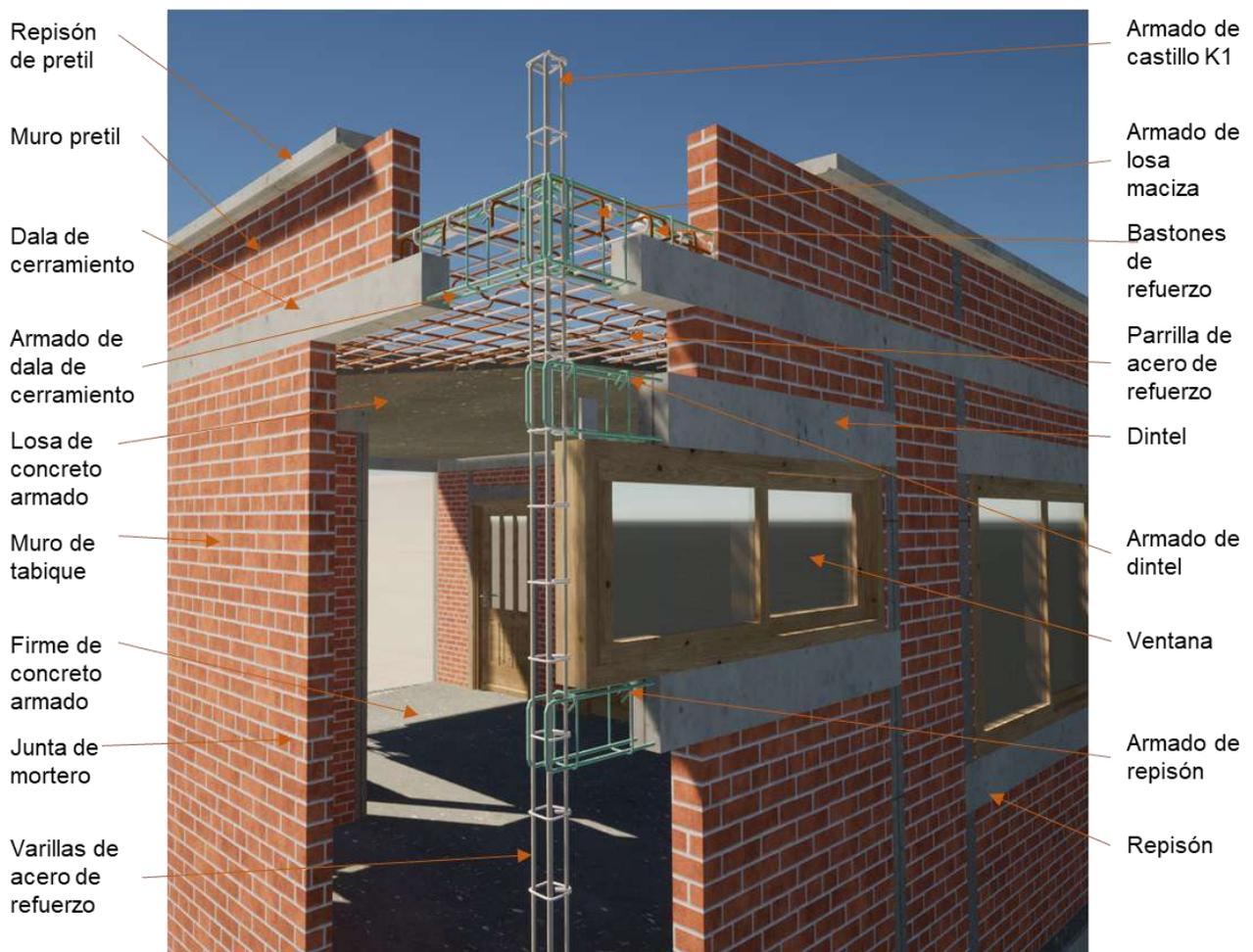
En lo referente a la losa de cubierta, esta se encuentra conformada por una parrilla de acero de refuerzo de forma reticular que contempla el reforzamiento con base en bastones de acero, con la finalidad de contribuir a la compensación de los esfuerzos de compresión en el lecho bajo de la losa hacia el centro de la misma, como puede apreciarse en la figura 87.
