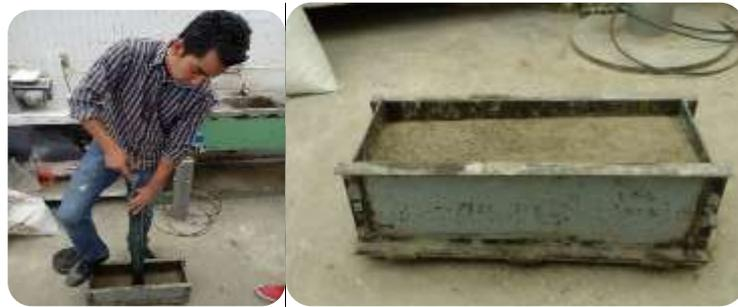
Figura 4. 25 Preparación de vigas para resistencia a la flexión
