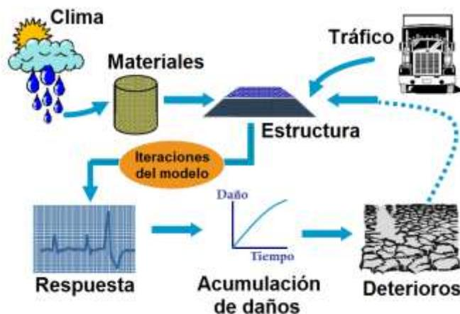
**Figura 2. 20 Factores que afectan el diseño de pavimentos**
