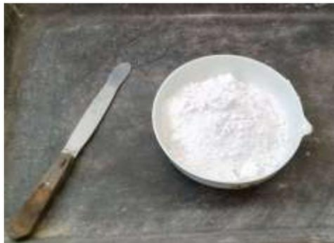
**Figura 4. 6 Muestra de Cal hidratada para experimentación**
