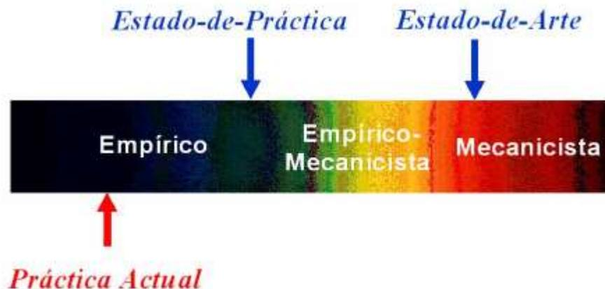
**Figura 2. 21 Esquema para ilustrar donde estamos en cuanto a métodos de análisis y diseño de pavimentos.**
