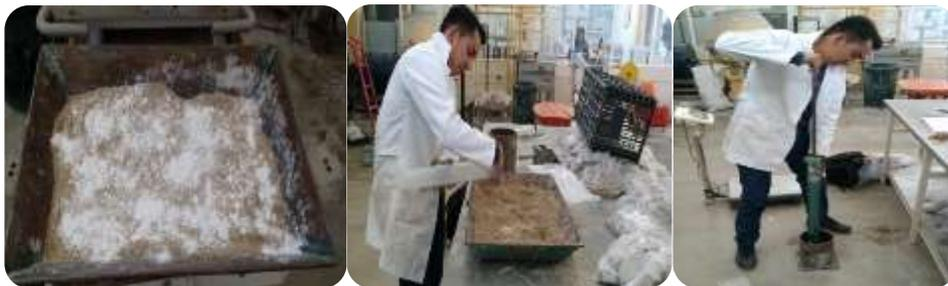
**Figura 4. 8 Procedimiento de ensayo proctor modificado con tepetate-cal**
