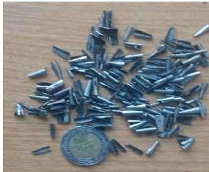
**Figura 4. 14 Fibras metálicas de acero “rebabas”.**
