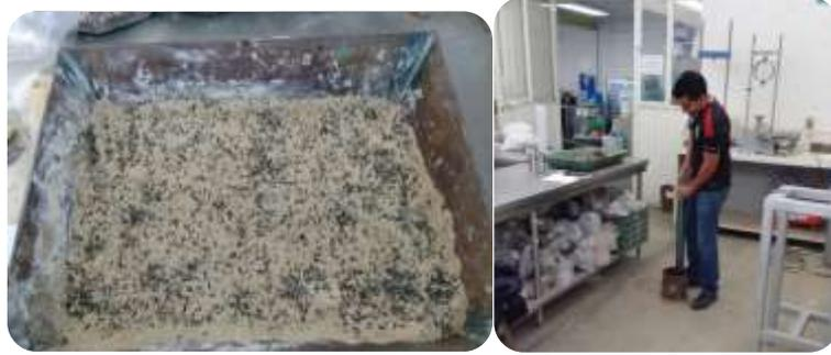
**Figura 4. 17 Procedimiento de ensaye proctor modificada para mezcla de tepetate-fibra**
