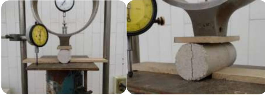
**Figura 4. 10 Procedimiento de ensayo de tensión indirecta en mezcla tepetate-cal**
