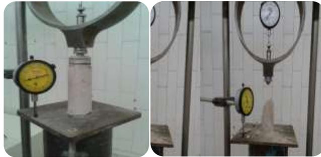
**Figura 4. 9 Procedimiento de ensaye de compresión simple de mezcla tepetate-cal**
