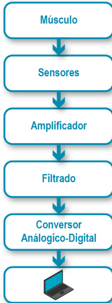
Fig. 1.7. Diagrama a bloques del módulo de electromiografía (Adaptado de Asghari Oskoei, M., & Hu, H., 2007).
