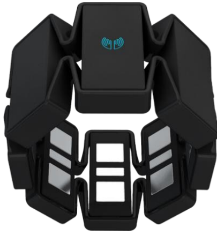
Fig. 3.1. Brazaletes Myo, lee la actividad eléctrica en los músculos mediante técnicas no invasivas (Myo, 2016).
