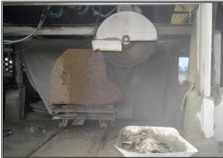
Figura IV- 3 Corte de la Piedra Cantera
