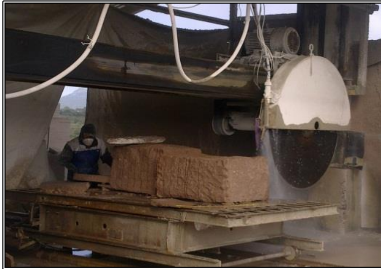
Figura IV- 4 Laminado de la Piedra Cantera
