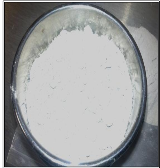
Figura III- 4 Preparación de muestras en tamiz malla 120
