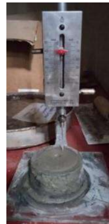
Figura 62 Medición de fraguado final.
