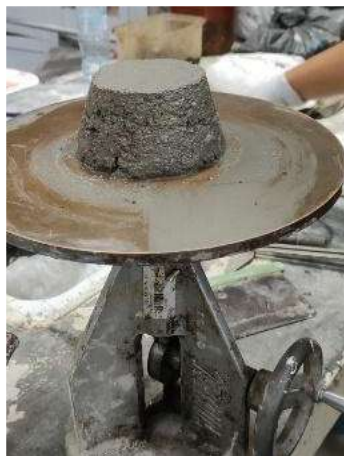
Figura 69 Mortero listo para la prueba de los 25 golpes.
