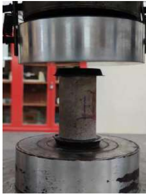
Figura 98 Colocación del espécimen cilíndrico para ensayo a compresión.
