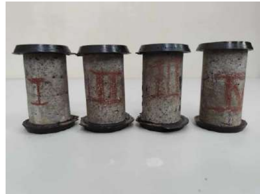
Figura 97 Especímenes cilíndricos con base de azufre en áreas de contacto.
