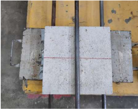
Figura 91 Acomodo de apoyos y aditamentos prueba de MOR.
