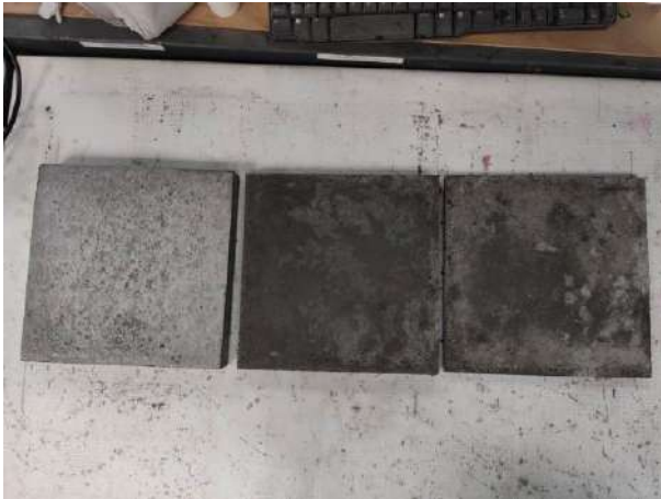
Figura 77. Paneles descimbrados de 3.0, 2.0 y 1.0 cm.
