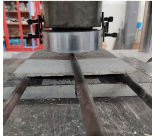
Figura 78 Prueba de Módulo de ruptura en cada grupo de prueba.
