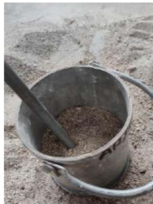
Figura 48 Varillado entre capas con un total de 25 por cada una.
