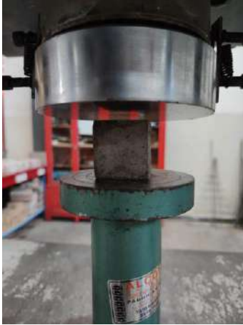
Figura 73 Colocación del espécimen cubico en prensa hidráulica.
