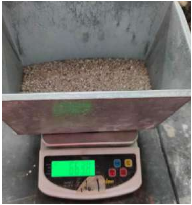
Figura 50 Muestra representativa para análisis granulométrico.
