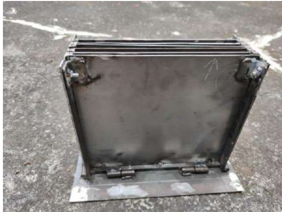
Figura 126 Elaboración de prototipo de molde con apertura lateral y apertura superior para vaciado.
