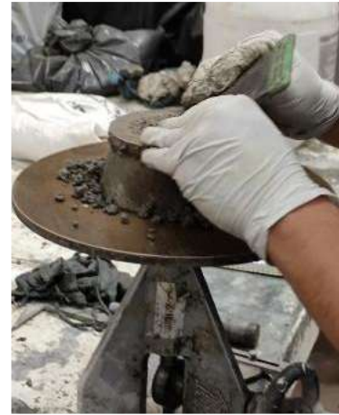
Figura 68 Enrasado del mortero.
