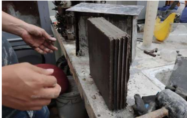
Figura 129 Alta adherencia de los panes de mortero a las placas de acero.
