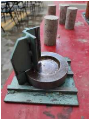
Figura 95 Base para vaciado de azufre.
