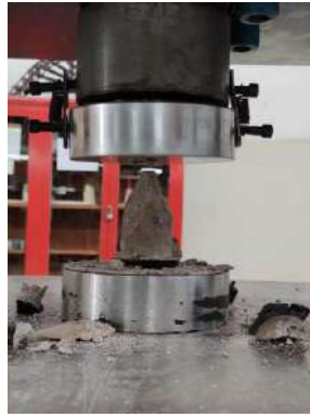
Figura 99 Falla del espécimen cilíndrico a compresión.
