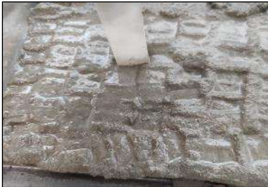
Figura 86 Apisonado con prisma acrílico.
