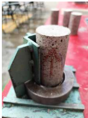
Figura 96 Preparación para una de las áreas de contacto del cilindro.
