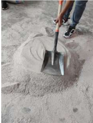
Figura 44 Cuarteo de arena por método manual.
