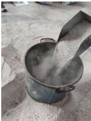
Figura 47 Se vacía el material de esquinas opuestas dejando caer a 5 cm la arena.
