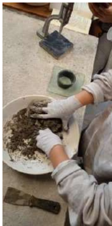
Figura 60 Preparación de la mezcla en molde.
