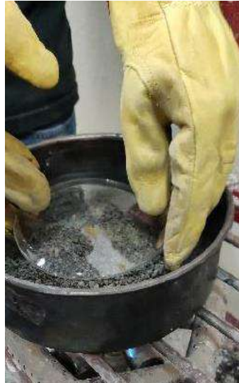
Figura 41 Arena en condición saturada y superficialmente seca. en Figura 42 Prueba de humedad en arena con placa de vidrio. de Figura 43 Registro de masa final M_s .
