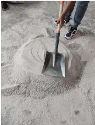
Figura 32 Aplanado de la parte superior del montículo con pala.
