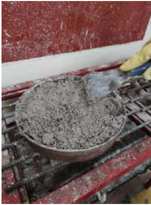
Figura 35 Secado de arena hasta alcanzar secado superficial.
