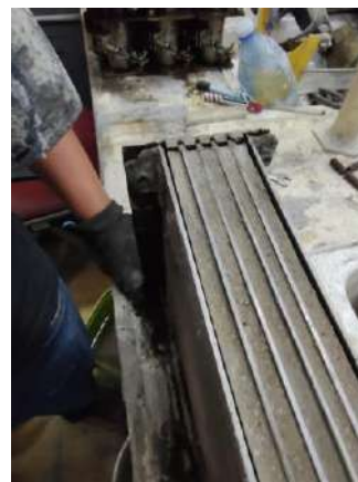
Figura 128 Desmolde de cinco especímenes de prueba.
