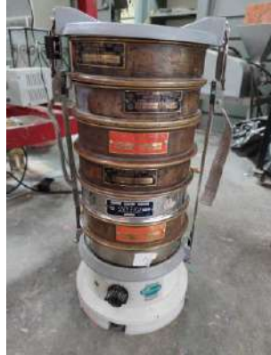
Figura 51 Tamices ordenados y colocados en el agitador para prueba.
