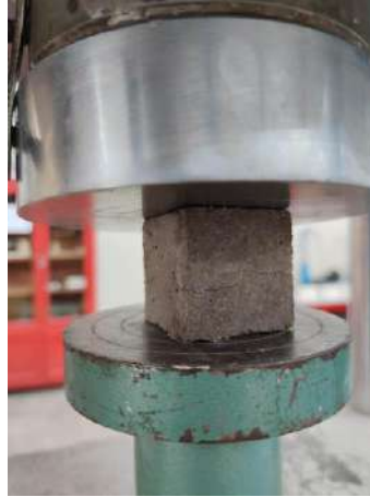
Figura 74 Aplicación de carga al espécimen cubico.
