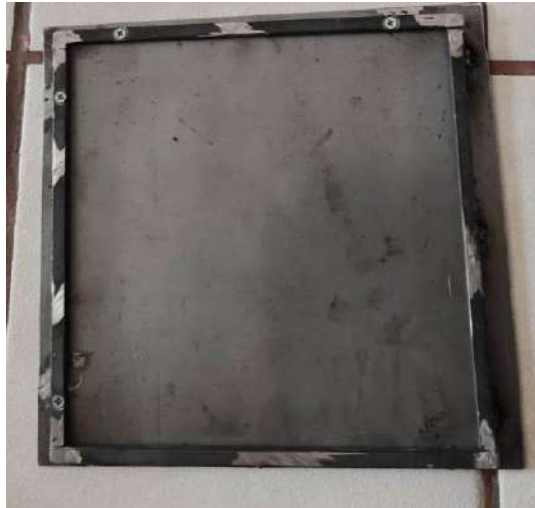
Figura 130 Molde final para vaciado de mortero de 1 cm de grosor.
