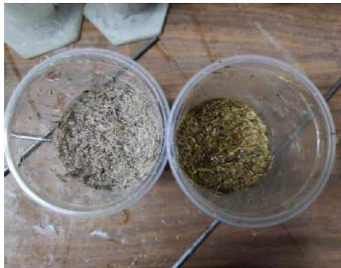
Figura 118 Comparativa entre fibra tratada y no tratada.
