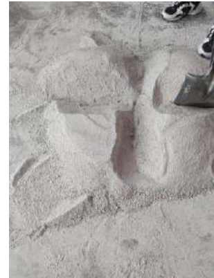
Figura 34 División en 4 partes del montículo, para descartar las diagonales.
