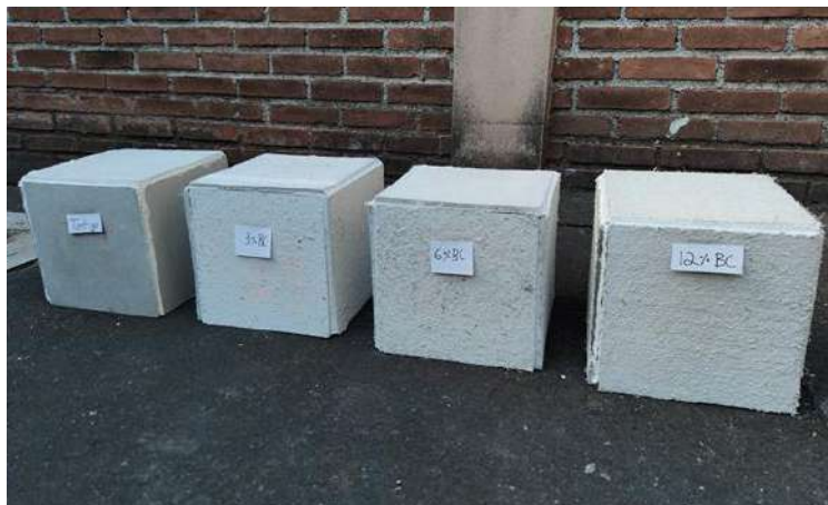
Figura 107 Cajas de prueba para aislamiento acústico.
