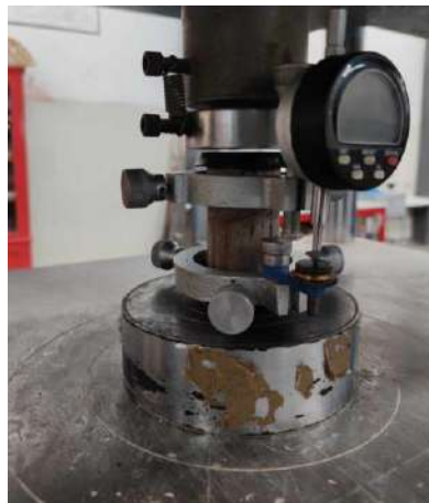
Figura 101 Aplicación de carga en el espécimen cilíndrico ya instrumentado.
