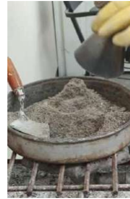
Figura 37 Prueba visual de disgregación.
