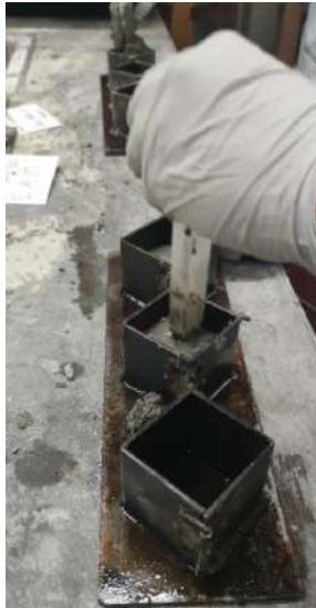
Figura 71 Apisonado de los especímenes
