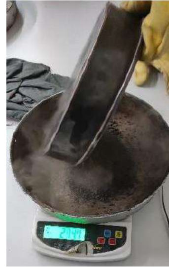
Figura 41 Arena en condición saturada y superficialmente seca. en Figura 42 Prueba de humedad en arena con placa de vidrio. de Figura 43 Registro de masa final M_s .
