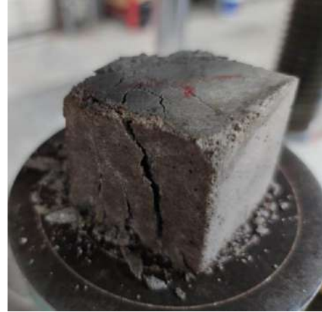
Figura 75 Falla del espécimen cubico.
