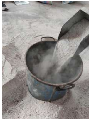
Figura 45 Llenado del recipiente con masa y volumen conocido.
