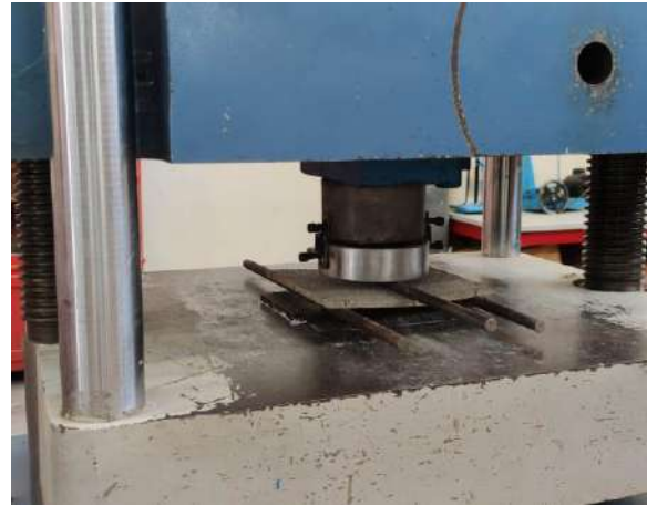
Figura 92 Prueba de Módulo de ruptura en placas.
