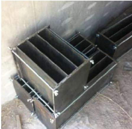
Figura 125 Modelo de moldes metálicos de la investigación de paneles prefabricados de paja de cereal y tierra estabilizada (Cobrerros Rodríguez, 2015).
