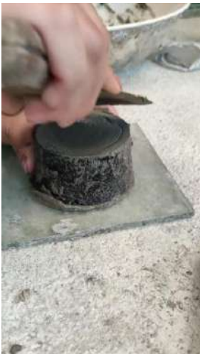
Figura 57 Pasta colocada en molde, enrasado.
