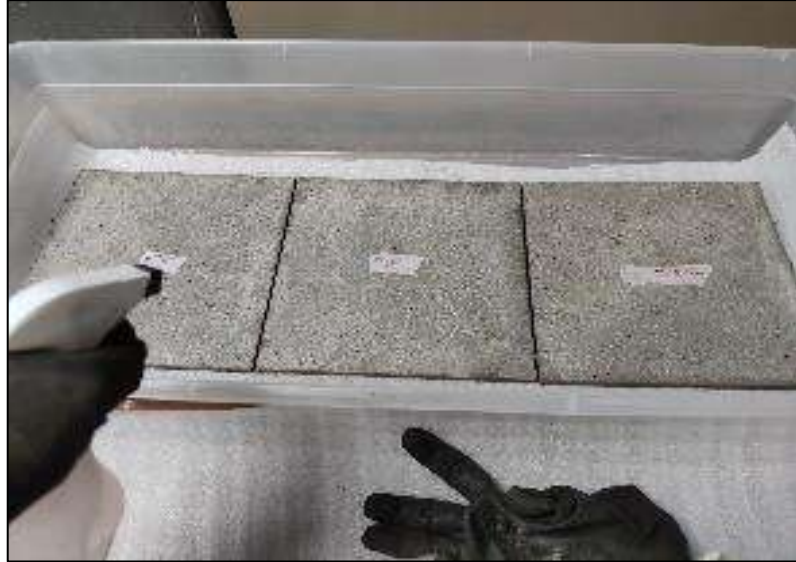
Figura 88. Colocación de paneles en recipiente hermético para curado a 7 y 28 días.
