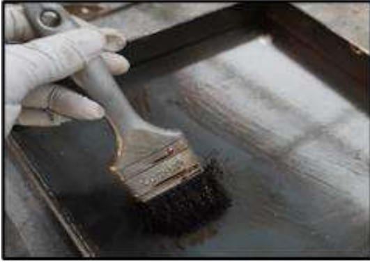
Figura 84 Engrasado de moldes.
