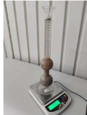
Figura 40 Registro del peso del recipiente más agua y arena, M_{ii} .
