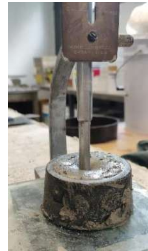
Figura 59 Penetración de aguja Vicat después de 30 segundos.
