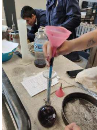
Figura 64 Introducción del cemento por medio de embudo.
