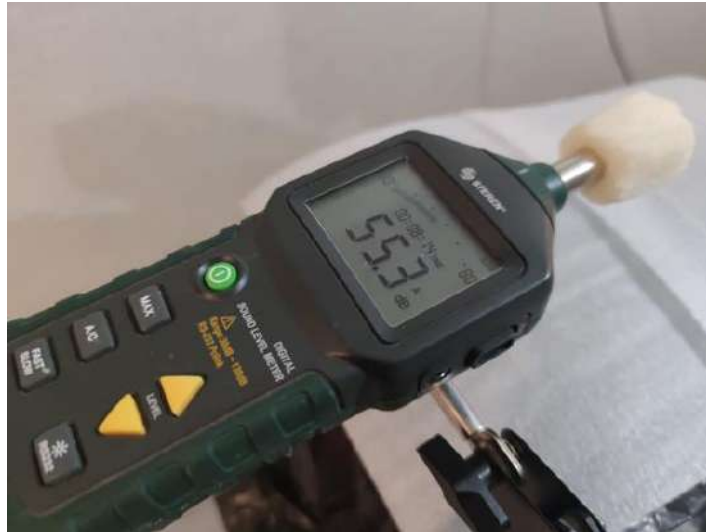
Figura 108 Calibración de la fuente de ruido a 55 dB.
