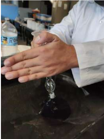
Figura 63 Frasco sumergido y siendo girado para liberar aire
