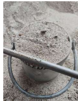
Figura 49 Se enrasa con la varilla punta de bala el material.
