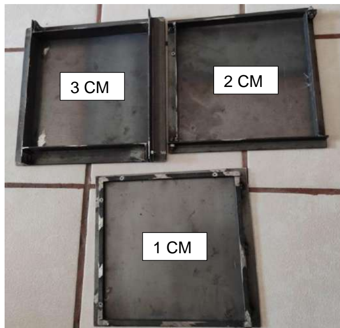
Figura 131 Moldes metálicos de 3.0, 2.0 y 1.0 cm para prueba para determinar el espesor de testigo.
