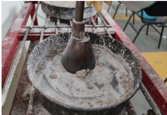
Figura 36 Apisonado de arena en molde tronco cónico.
