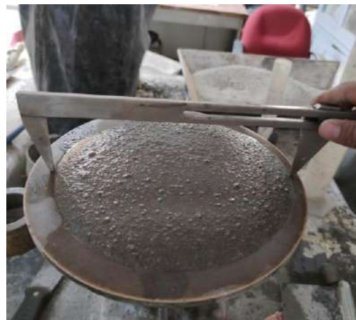
Figura 70 Medición del diámetro extendido de la mezcla de mortero.
