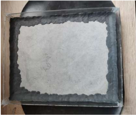
Figura 104 Sellado de placa en los bordes. Figura 105 Colocación de agua a 20mm por encima de la placa.
