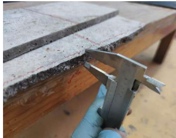
Figura 94 Medición del espesor por la línea de falla.
