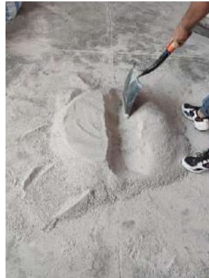
Figura 33 Trazado de líneas divisorias en montículo para posterior descarte.
