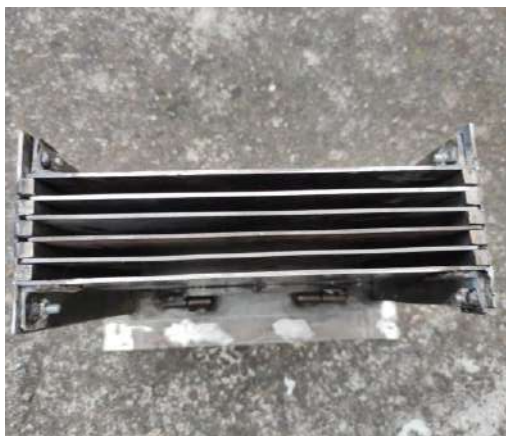
Figura 127 Vista de parte superior (acomodo de láminas verticales removibles).
