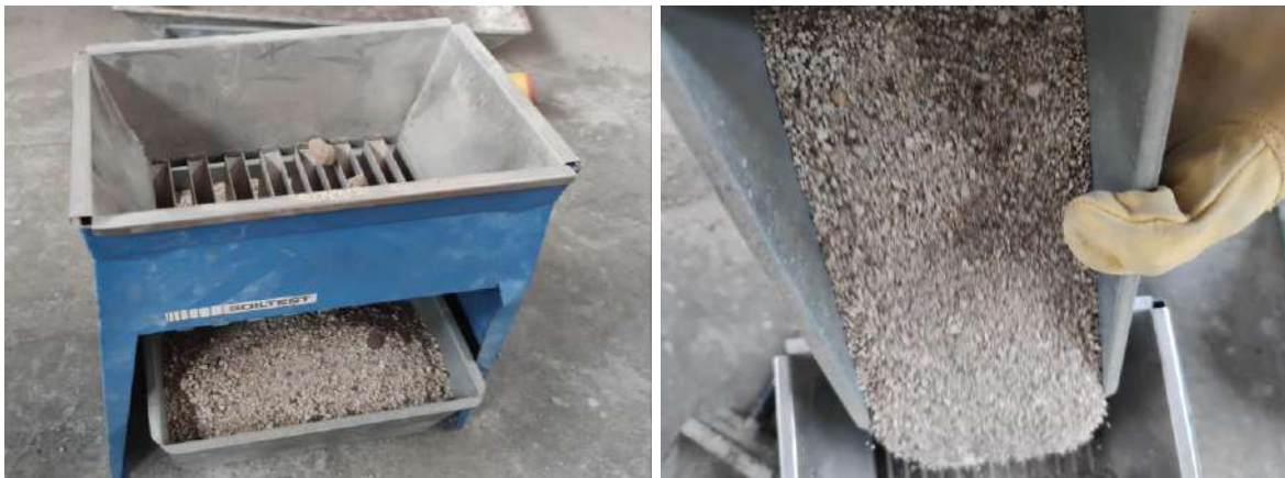
Figura 31 Material vertido a ambos lados del cuarteador y nuevo vaciado del material restante.
