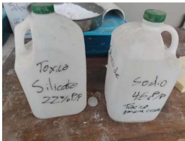
Figura 24 Silicato de sodio preparado con una concentración del 22% .
