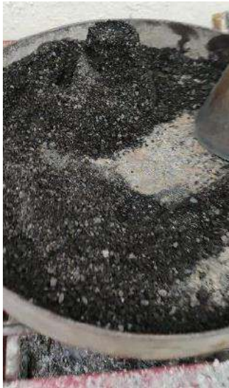
Figura 41 Arena en condición saturada y superficialmente seca. en Figura 42 Prueba de humedad en arena con placa de vidrio. de Figura 43 Registro de masa final M_s .
