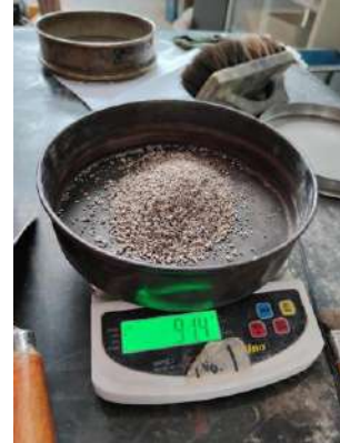
Figura 52 Pesado de material de cada una de las mallas retenidas.
