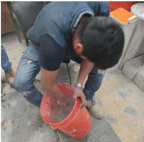
Figura 82 Homogenización a mano.
