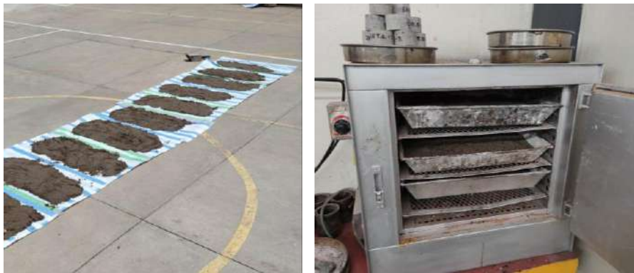
Figura 28 Secado de arena de río en laboratorio.
