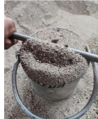
Figura 46 Enrase con varilla punta de bala del recipiente.
