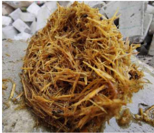
Figura 25 Fibras de bagazo de caña tratadas con silicato de sodio.
