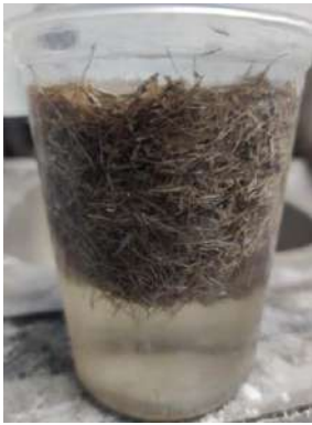
Figura 115 Saturación de la fibra por 24 h.
