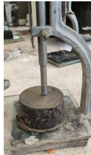
Figura 58 Colocación de pasta, en el aparato Vicat.
