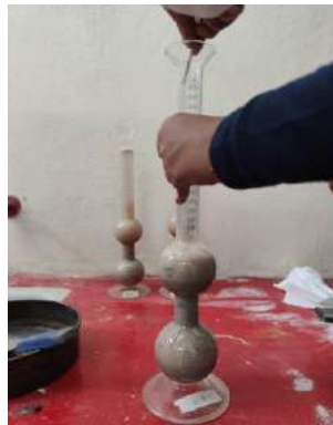
Figura 39 Llenado de recipiente con arena superficialmente seca.
