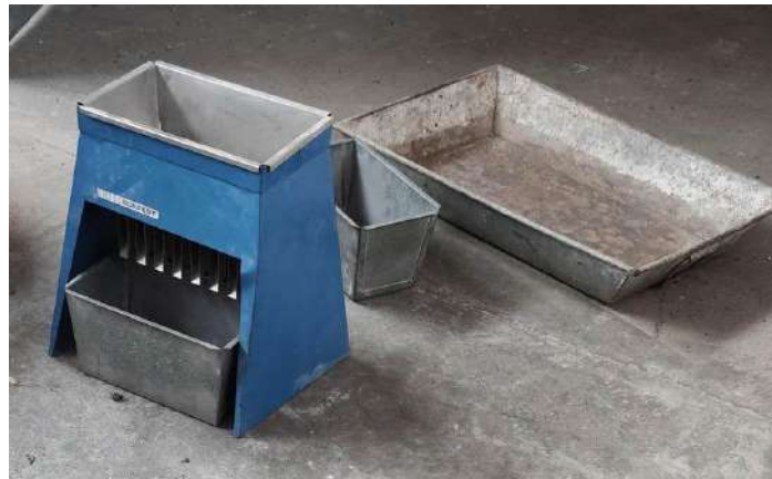
Figura 29 Cuarteador colocado en piso para prueba.
