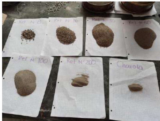
Figura 53 Distribución de partículas según lo retenido en los tamices.
