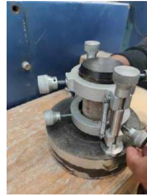
Figura 100 Fijado del espécimen con aditamento para medir deformaciones.
