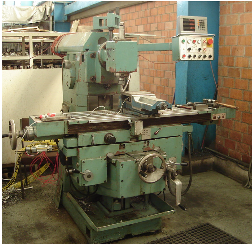
Figura A.3-6: Caracterización dinámica de máquina fresadora convencional marca TOS con un cortador recto de 9.525 mm (3/8”) de diámetro y 38 mm (1 ½”) de longitud.
