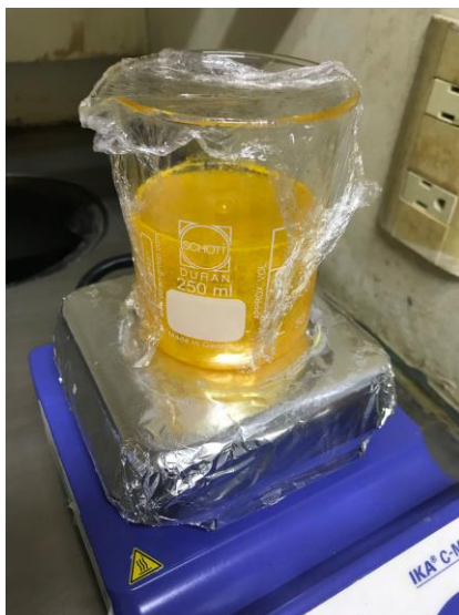
Figura 2. Procedimiento de síntesis de películas de CdS por baño químico.
