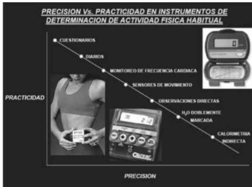
**Figura 2.2** Precisión vs practicidad de diferentes instrumentos para medir la AF (Rowland,1996).
