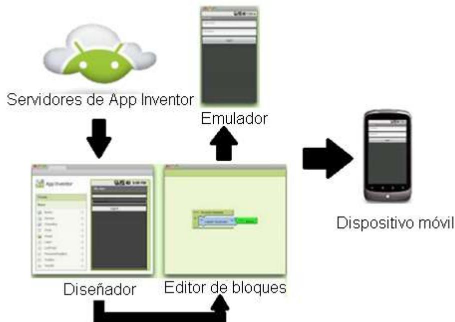
**Figura 2.9** Diagrama básico de creación de una App en App Inventor.
