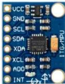
**Figura 2.8** Pines del módulo MPU6050 (5Hertz, 2018).
