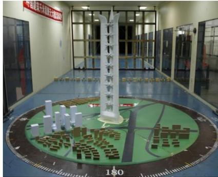
Figura 1-3. Ensayo en túnel de viento de un edificio kilométrico en China (Sun *et al.*, 2017)
