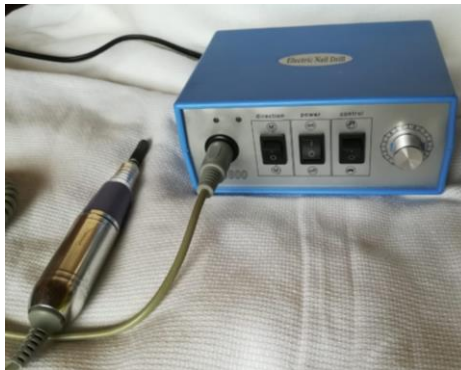
Figura 39. Equipo usado lijar granos de maíz lista para su uso encendido.
