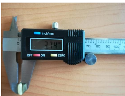
Figura 35. Grosor del grano de maíz determinada con vernier digital
