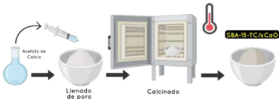
Figura 7: Esquema del procedimiento para la impregnación por llenado de poro
