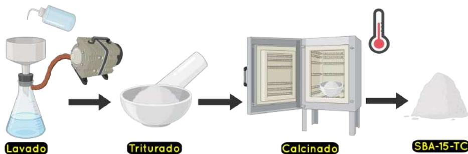
Figura 5: Esquema del procedimiento de preparación de la SBA-15-TC (Parte B)
