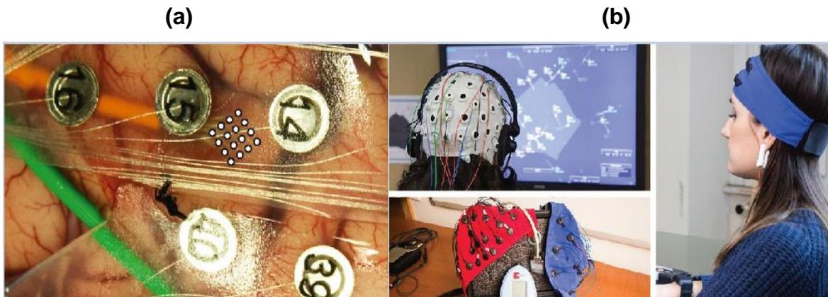
**Figura 2.1** Tipos de electrodos. a) Electrodo de tipo invasivo y b) electrodo de tipo no invasivo.
