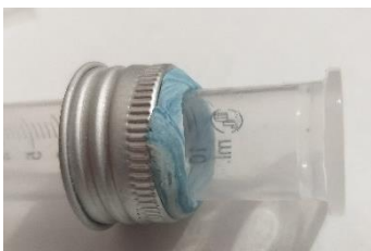
Figura 4. Jeringa sellada con Plasti Loka a la tapa del frasco de cristal
