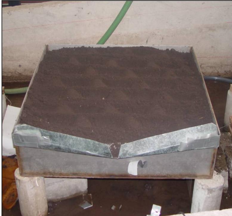
**Figura 3.3. Caja experimental Rugosidad Geométricamente Ordenada.**
