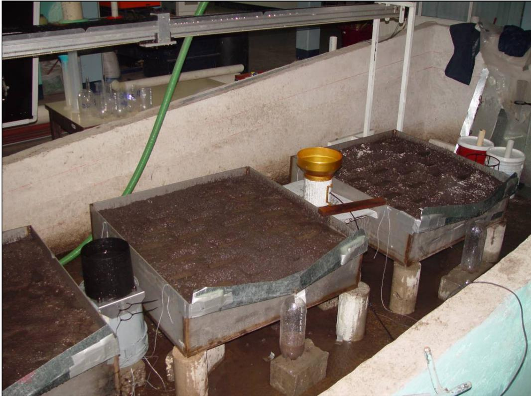
***Figura 3.6. Ubicación de los pluviómetros digitales.***
