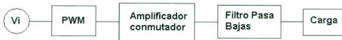
FIGURA 1 DIAGRAMA GENERAL DE BLOQUES DE UN SISTEMA AMPLIFICADOR CLASE D
