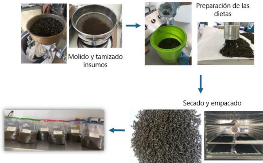
Figura 7. Diagrama de procesamiento de los insumos (microalga y larva de mosca) para la elaboración de las dietas experimentales.
