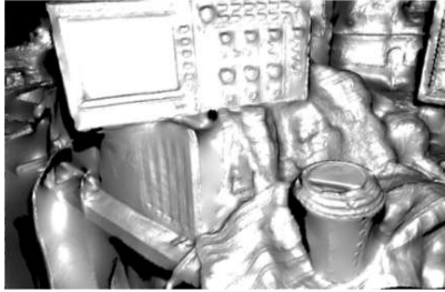
Figura 3: Resultado del proceso SLAM Denso [11]
