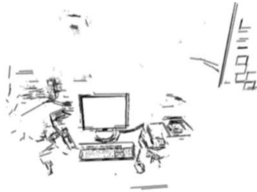
Figura 2.5: Resultado del proceso SLAM (nube de puntos) [10]
