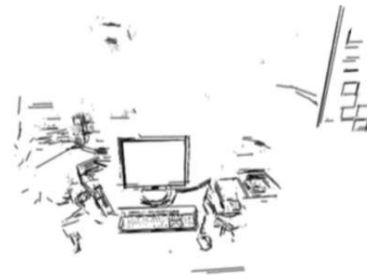
Figura 2: Resultado del proceso SLAM (nube de puntos) [10]
