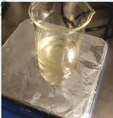
Figura 4.4 Agitación de quitosano en polvo con 99% de ácido acético 1 v/v
