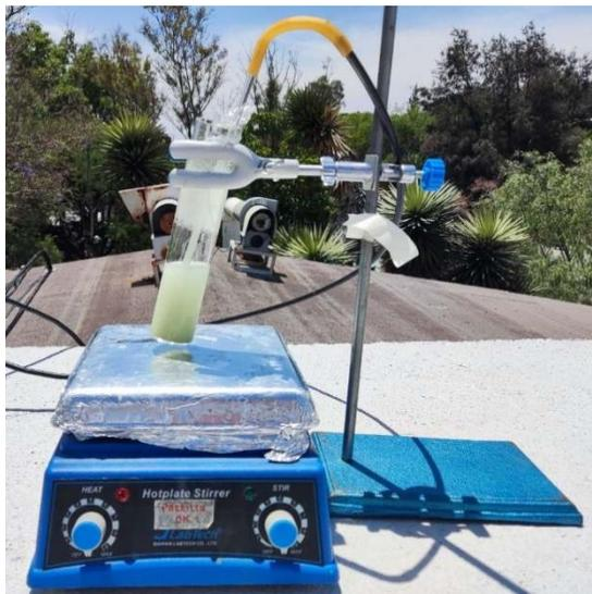
Imagen 4. Montaje de pruebas de fotorreducción de CO<sub>2</sub> con luz solar.
