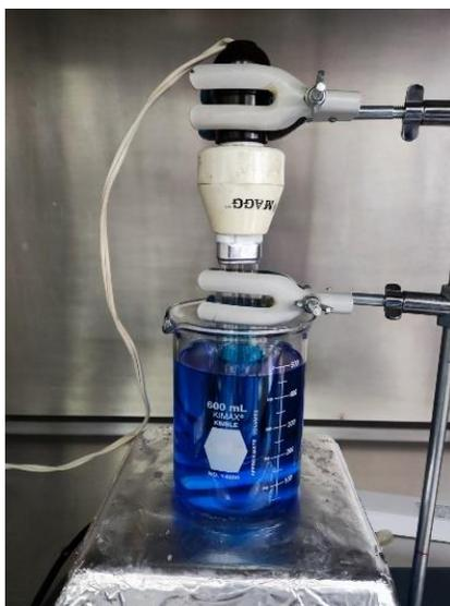
Imagen 1. Montaje para las pruebas de fotodegradación de AM con lámpara.
