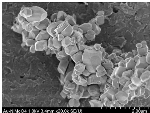
Figura 19. Imagen SEM a 20000 aumentos de los polvos obtenidos por sol-gel sinterizados a 700 °C con NP Au.
