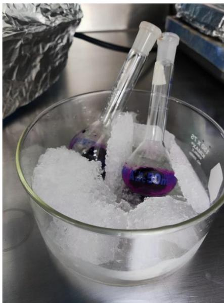
Imagen 5. Solución de  $\text{KMnO}_4 + \text{H}_3\text{PO}_4$  y la muestra en baño frío.
