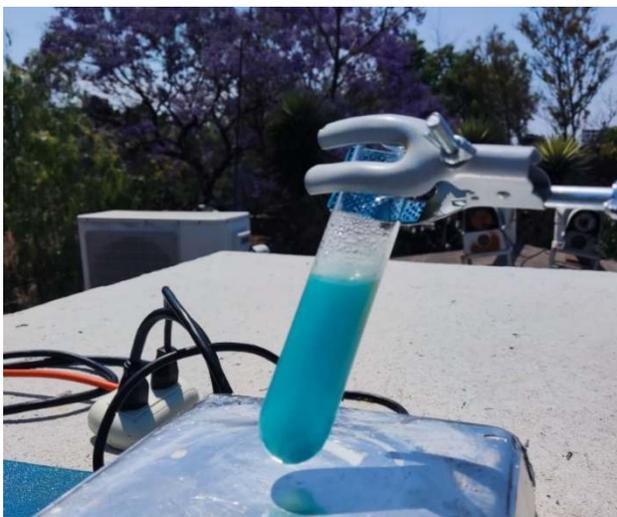
Imagen 2. Montaje para las pruebas de fotodegradación de AM con luz solar.
