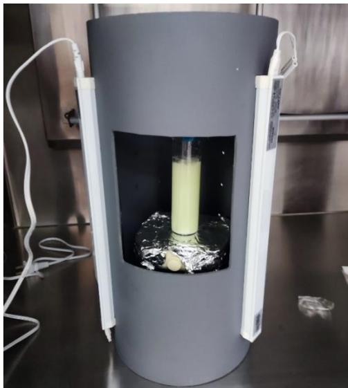
Imagen 3. Montaje para las pruebas de fotorreducción de  $\text{CO}_2$  con lámparas.
