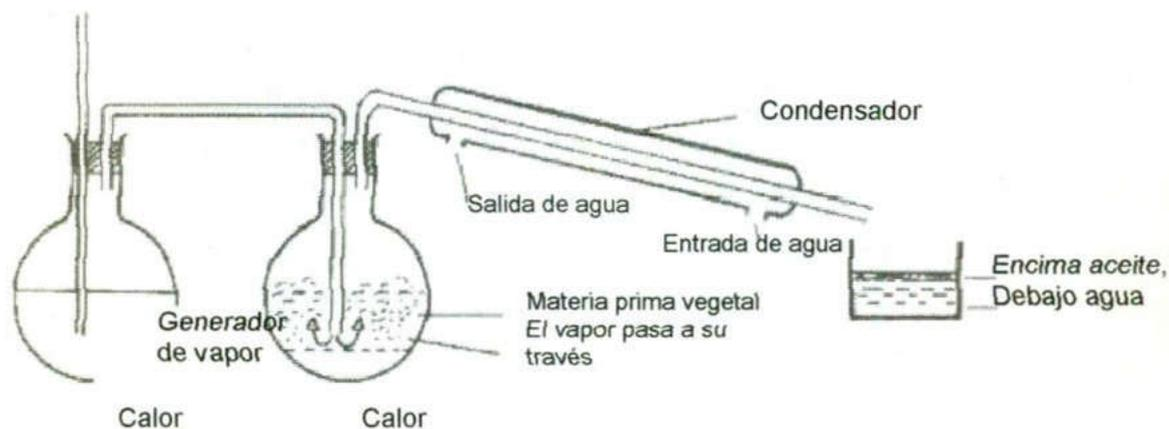
Fig. 10.2. Destilación por arrastre de vapor en el laboratorio.
