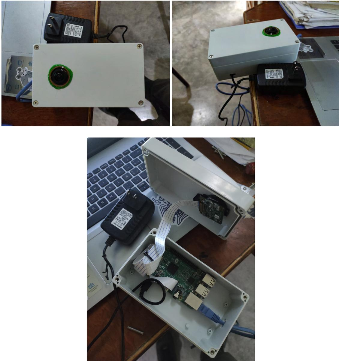
Figura 4.17: Imágenes del prototipo listo para colocarse en cualquier zona donde se desee clasificar nubes.
