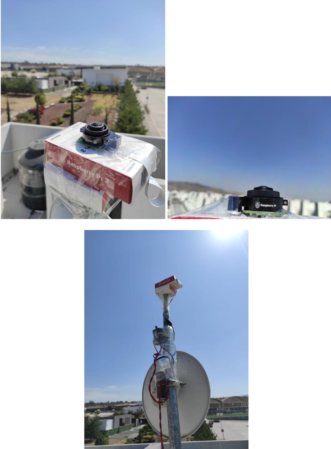
Figura 4.15: Setup local para capturar las imágenes de cielo completo (primera fase).
