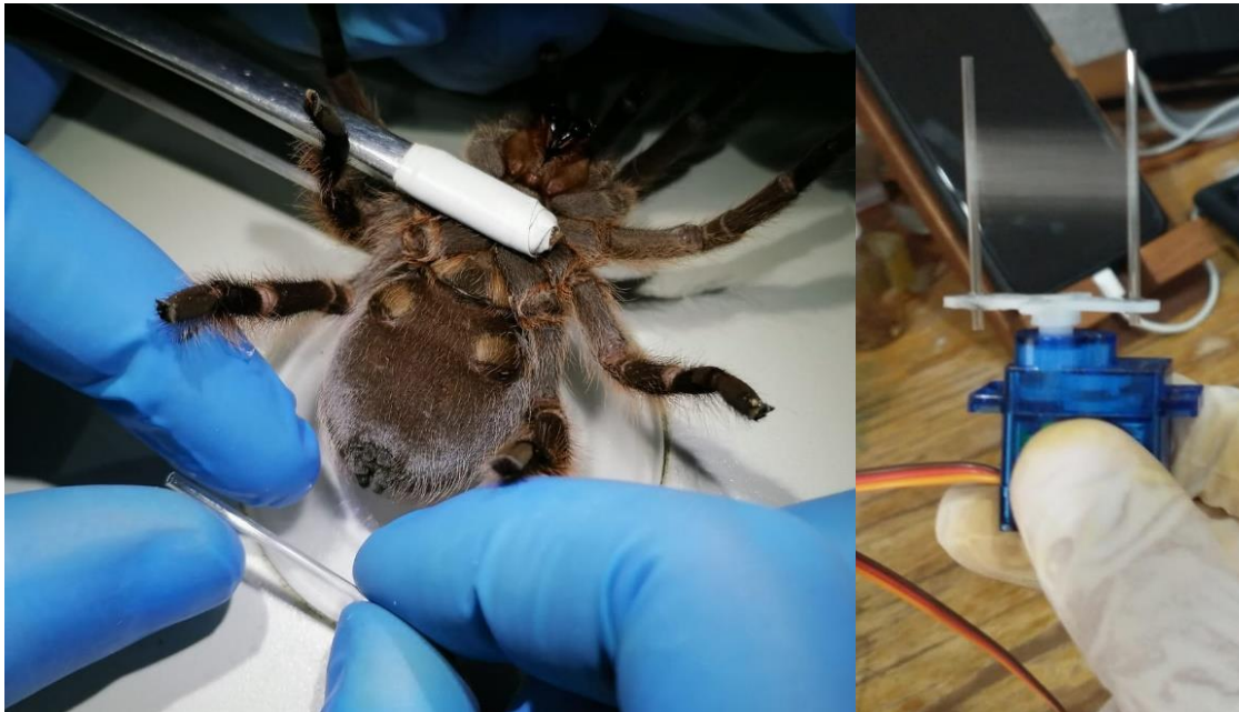
Figura 3. Extracción de seda de tarántula usando dos capilares como carrete y servomotor programado con Arduino.
