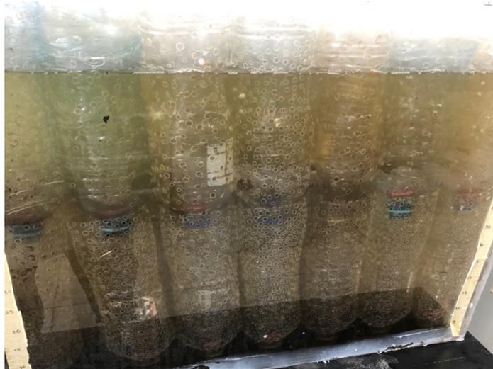
Figura 2. Biorreactor a los 10 días de alimentación con lodos y agua residual.
