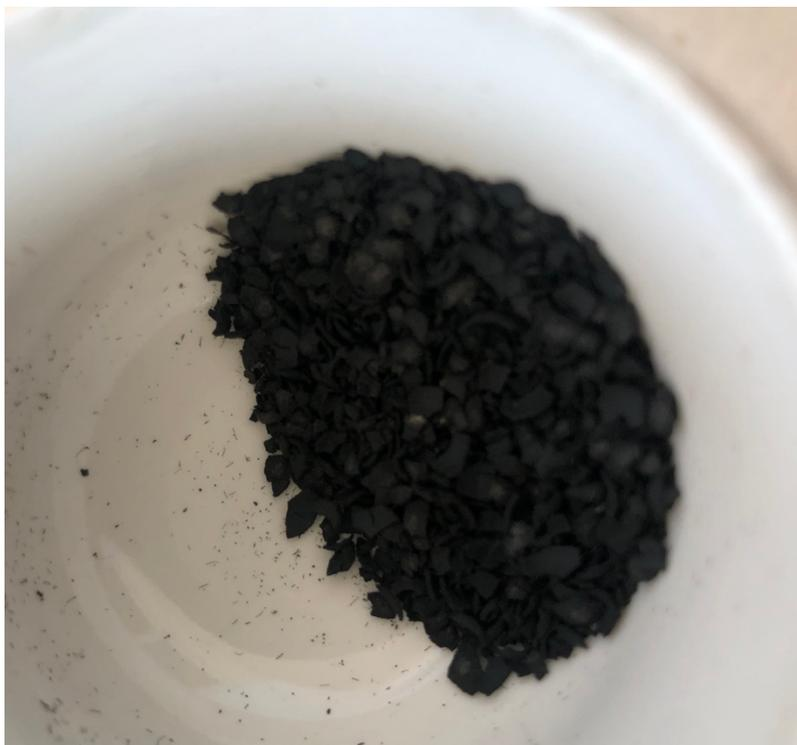
Figura 8. Óxido de grafeno sintetizado por el método de hummers modificado.
