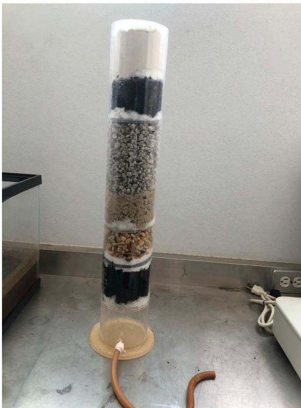
Figura 17. Filtro empacado con la membrana y materiales adsorbentes.
