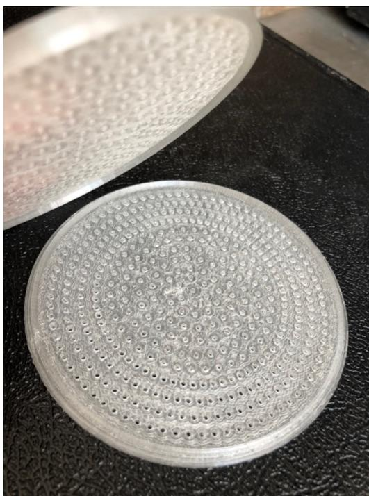
Figura 16. Membrana polimérica fabricada por Impresión 3D
