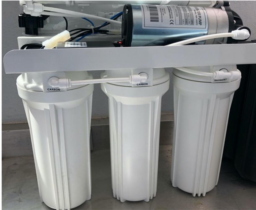
Figura 5. Filtros empacados, 2 filtros de carbón activado y uno de zeolita y osmosis inversa localizada en la parte superior.
