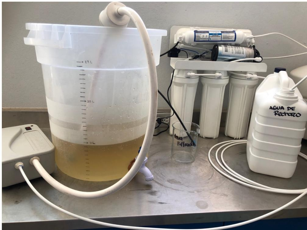
Figura 15. Sistema de filtración operando con agua tratada del reactor biológico.
