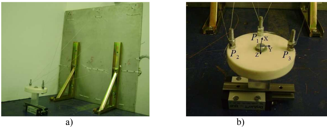
Figura 3.25. Configuración para los experimentos con Milli-CaTraSys: a) Una vista general; b) El órgano terminal con la configuración 3-2-1.
