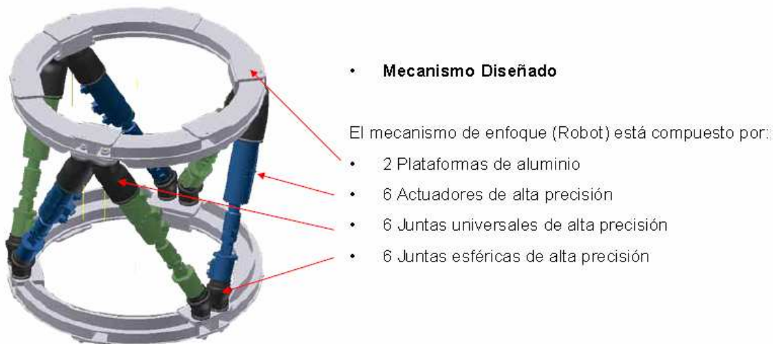
Figura 3.33. Un modelo CAD del Hexápodo de alta precisión.
