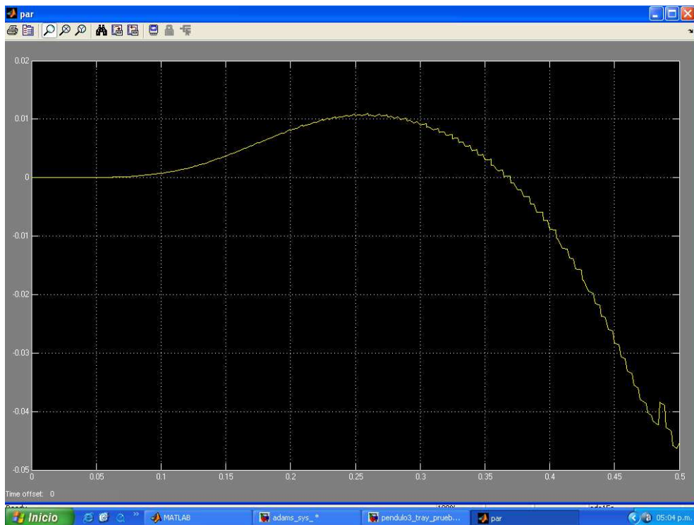
Figura 5.38. Par de entrada necesario para que la cadena cinemática de entrada siga la trayectoria deseada.
