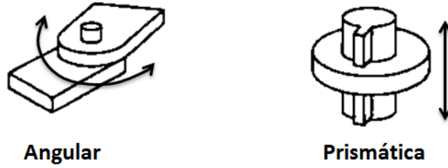
Figura 2.2: Articulaciones angulares y prismáticas, usadas para el diseño de un robot manipulador (Craig, 2006).
