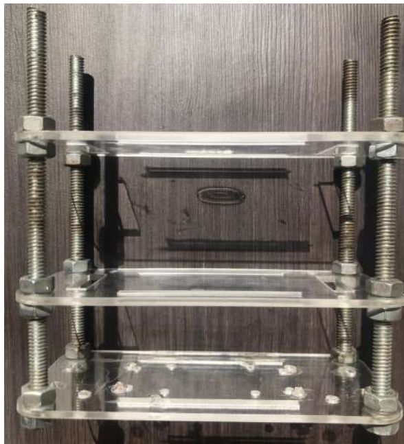
Figura 4.1: Estructura del robot balancín sin componentes electrónicos.
