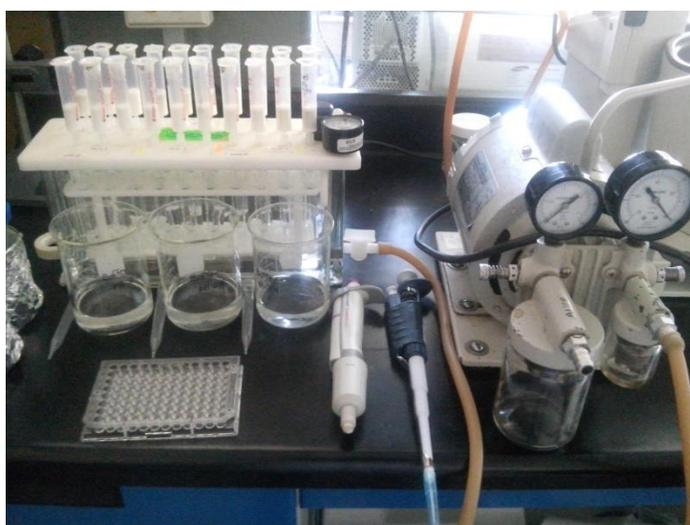
**Figura 13** Cámara cromatografía acoplada a bomba de vacío.
