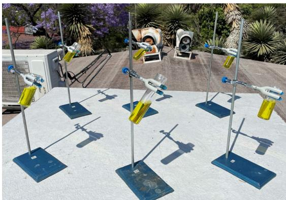
Figura 14. Fotografía de prueba de degradación de tartrazina con luz solar, en el Laboratorio de Materiales Avanzados de la UAQ, unidad centro.
