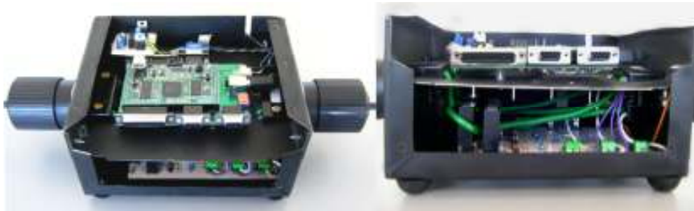
Fig. 19. Sistema de monitoreo eléctrico basado en FPGA
