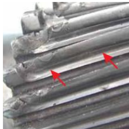
Figura 6. Engrane con desgaste en sus dientes (Fuente: Espejo y Martínez, 2008).
