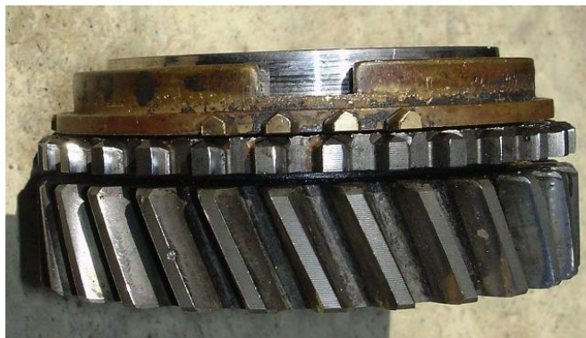
Figura 16. Sincronizadores con corrosión (Fuente: Foro coches, 2014).
