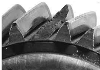
Figura 9. Diente con falla por fractura (Fuente: Espejo y Martínez, 2008).
