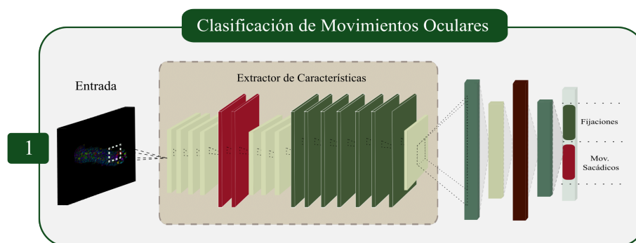
Figura 4.1: Primera etapa de entrenamiento del modelo: clasificación de eventos de movimientos oculares [creación propia].
