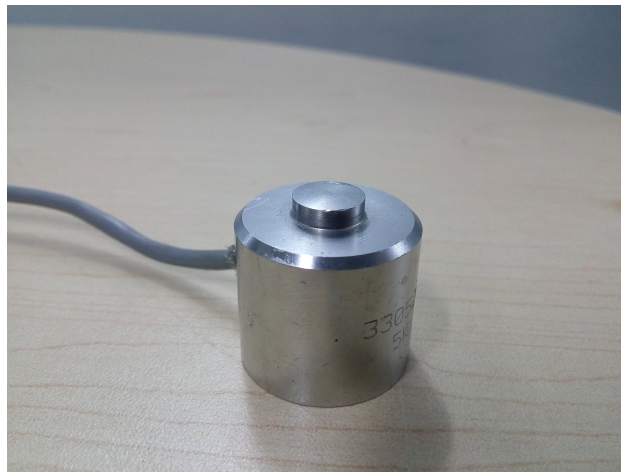
Figura 4.8: Celda de carga de botón Omega LM304-5K
