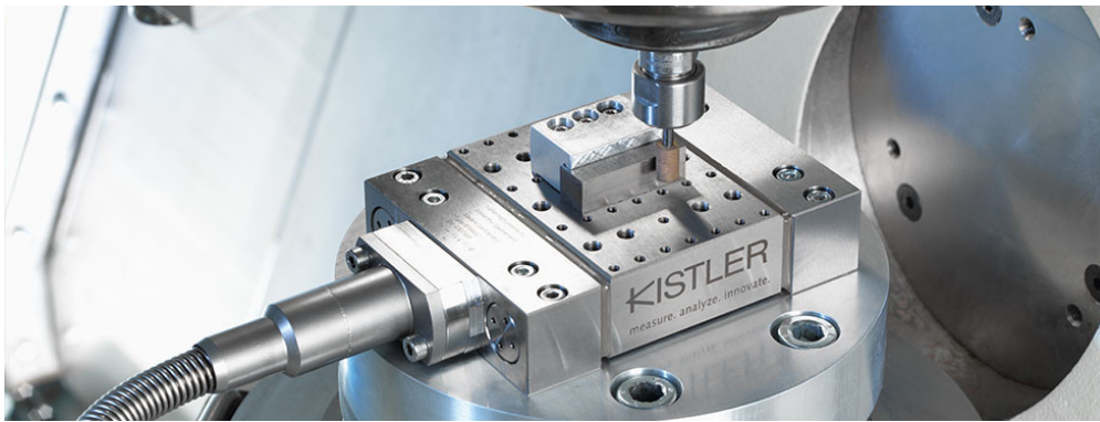
Figura 2.1: Dinamómetro para medición de fuerzas de corte, cortesía de Kistler [44]
