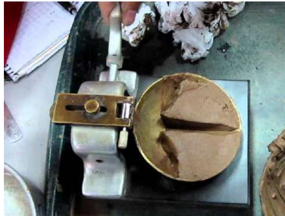
Figura 3.7 Método de la copa de Casagrande
