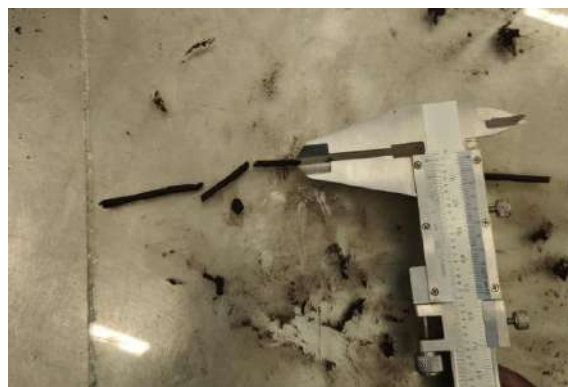
Figura 3.8 Método del rollo de arcilla.
