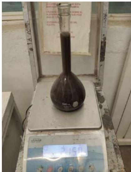
Figura 3.6 Preparación de la prueba de densidad de suelos
