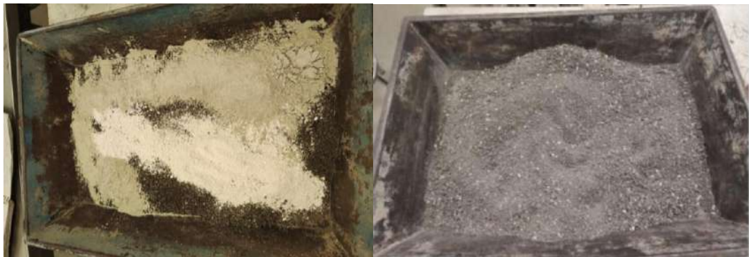
Figura 3.16 Dosificación y mezclado de suelo, cal y zeolita.
