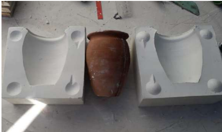
Figura 12. Proceso de fabricación de moldes de yeso a partir de una vasija de barro cocido. Archivo personal
