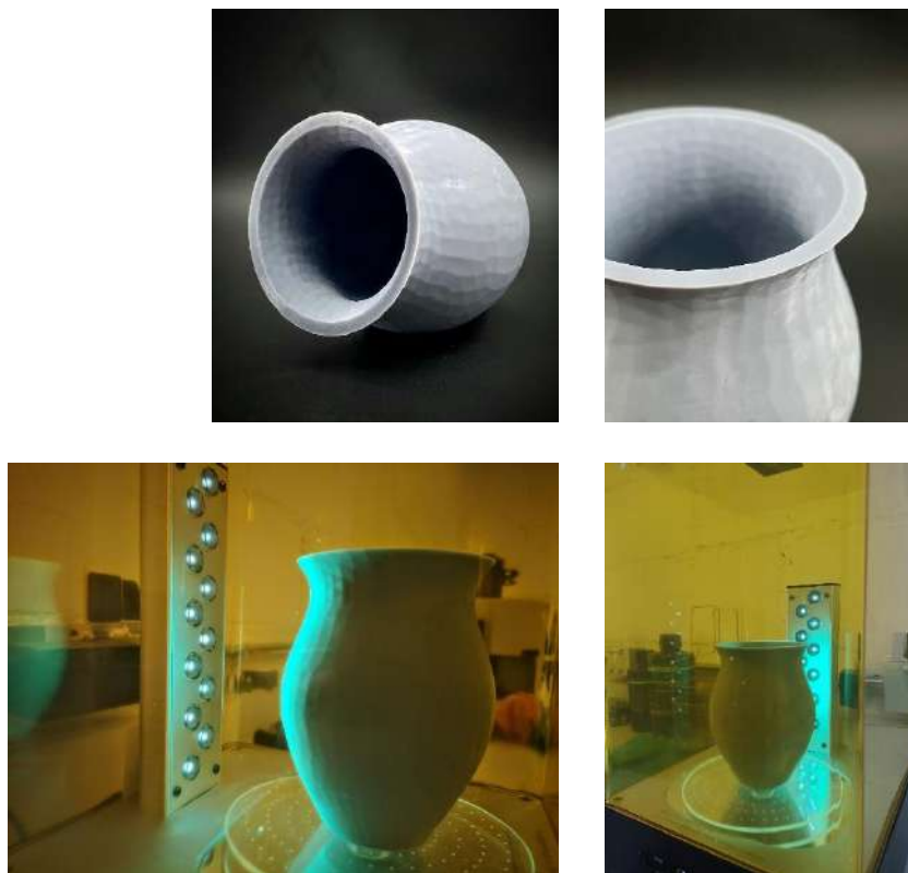
Figura 6. Proceso de impresión en 3D de la vasija. Archivo personal
