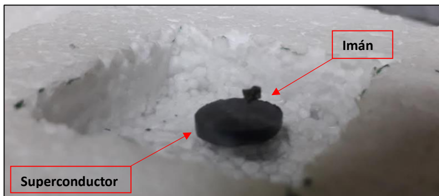
Figura 14. Levitación de imán sobre blanco superconductor enfriado con nitrógeno líquido.
