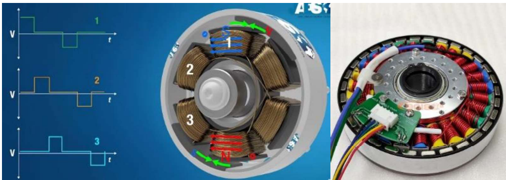
Figura 2.4. Composición y funcionamiento del motor brushless.
