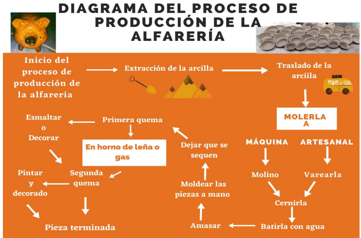
Diagrama del Proceso de la Alfarería.
